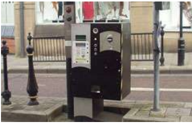
O antigo sistema de pagamento em cabine de taxa de congestionamento de Durham, R.U. Atualmente o sistema usa o reconhecimento automático das placas de matrícula.
